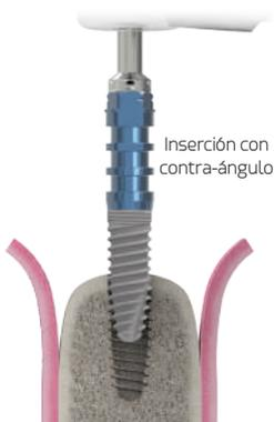
Inserte el implante en el lecho quirúrgico, controlando la dirección e inclinación. Cuando realice la inserción con contra ángulo, utilice una velocidad máxima de 25 Rpm. El torque recomendado de inserción se encuentra entre los 35 y 50 Ncm según cada caso sin limitarse a un torque único.
