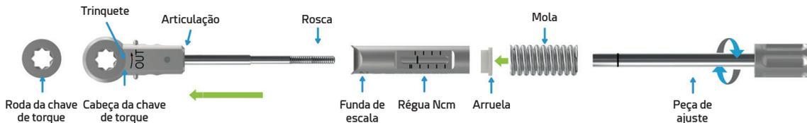
**NOTA:** Ao desenroscar a peça de ajuste, os componentes separam-se. Para voltar a montar a chave de torque, basta colocar as peças pela mesma ordem e enroscar a peça de ajuste.
