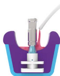
Injectar material de su elección alrededor del pilar de impresión hasta el nivel adecuado para obtener una correcta simulación de los tejidos blandos.
