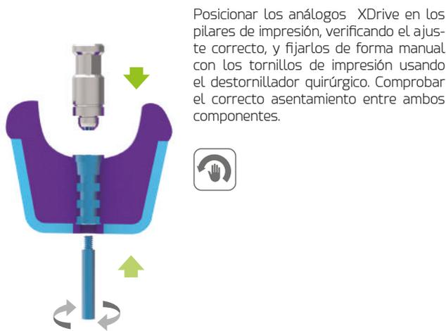
Posicionar los análogos XDrive en los pilares de impresión, verificando el ajuste correcto, y fijarlos de forma manual con los tornillos de impresión usando el destornillador quirúrgico. Comprobar el correcto asentamiento entre ambos componentes.
