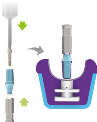
Posicionar el pilar Z2Plus sobre el análogo, verificando el ajuste correcto en la conexión, y colocar el tornillo de laboratorio manualmente con destornillador quirúrgico. Introducir el conjunto pilar-análogo en el transfer de impresión retenido en el material de impresión, orientando el plano anti rotacional hacia vestibular. Comprobar el correcto asentamiento entre ambos componentes.
