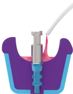
Inyectar material alrededor del pilar de impresión hasta el nivel adecuado para obtener una correcta simulación de los tejidos blandos.
